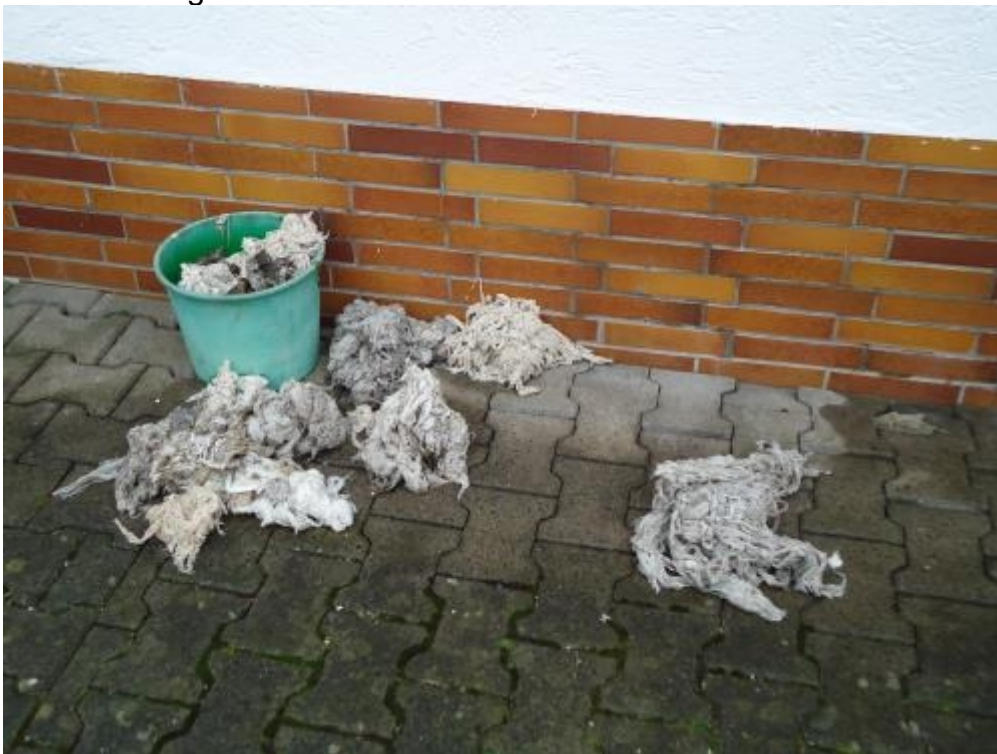
Bild: Textil-Bodenwischer (Wischmopp) die zu Störungen der Kläranlage Marjoß führten.
